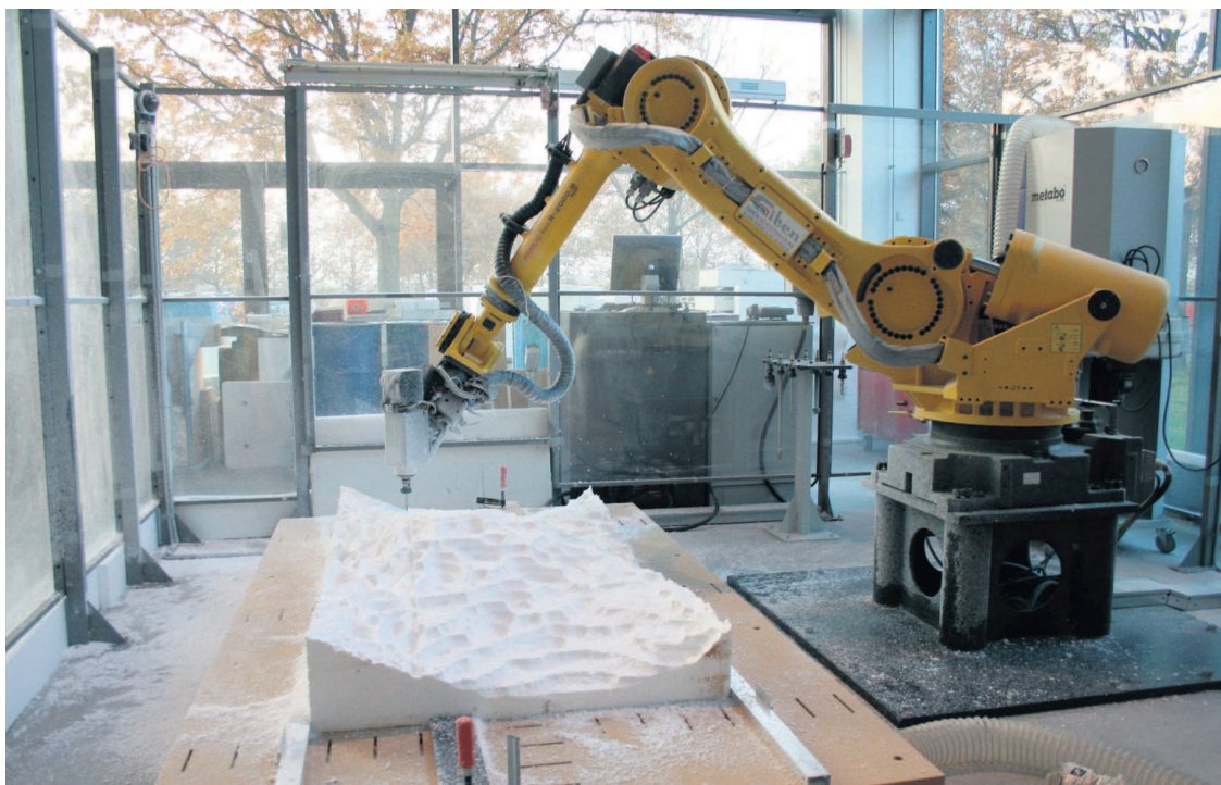
Robotten fræser formerne i polystyren, også kendt som flamingo. Når formen er brugt, kan materialet genbruges, hvilket gør metoden billig og bæredygtig. FOTOS: TEKNOLOGISK INSTITUT
