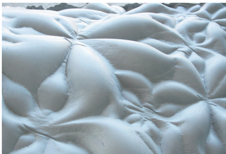
Ved at lægge duge over støbeformen kan man give betonen forskellige overflader.
